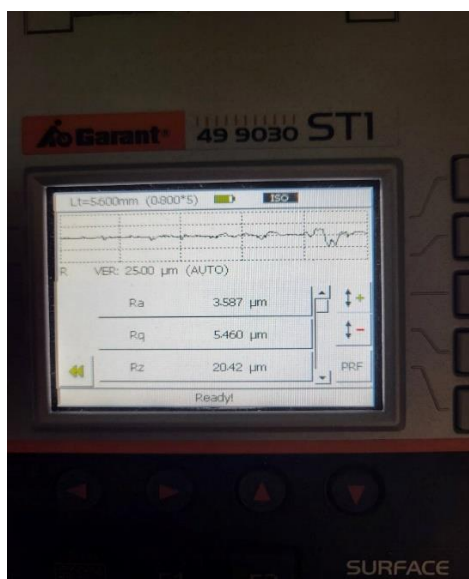
Slika 38. Prikaz zaslona uređaja za mjerenje hrapavosti
