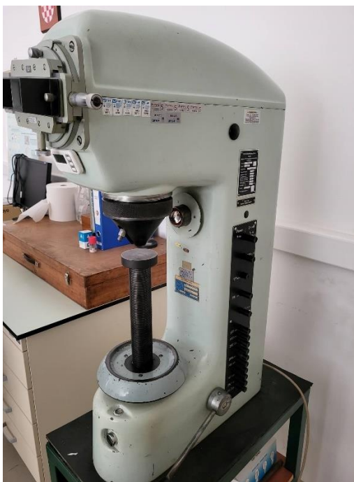
Slika 47. Uređaj na kojemu je provedeno ispitivanje tvrdoće
