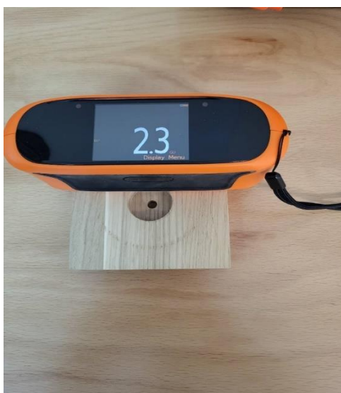
Slika 30. Prikaz mjerenja sjajnosti površine
