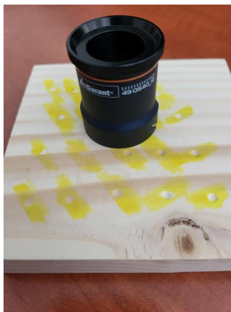
Slika 50. Prikaz mjerenja promjera otiska čelične kuglice
