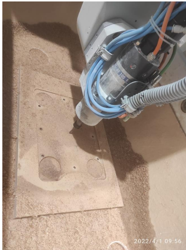
Slika 24. Glodanje utora za metalno postolje.
