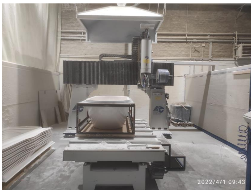
Slika 23. Priprema za glodanje utora.
