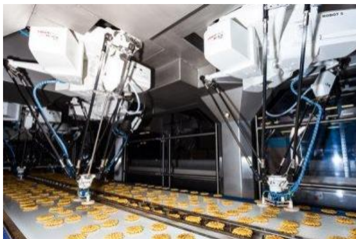
Slika 11. Delta robot u prehrambenoj industriji [17].
