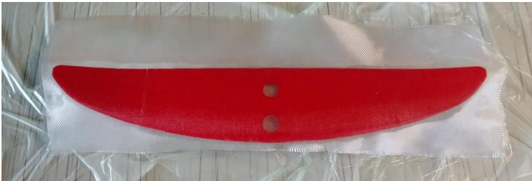
Slika 52-Slojevito pojačanje zadnjeg krila
