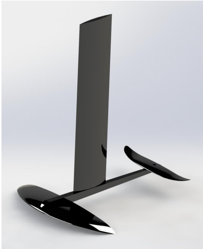
Slika 58-Prikaz hydrofoila u 3D programu
