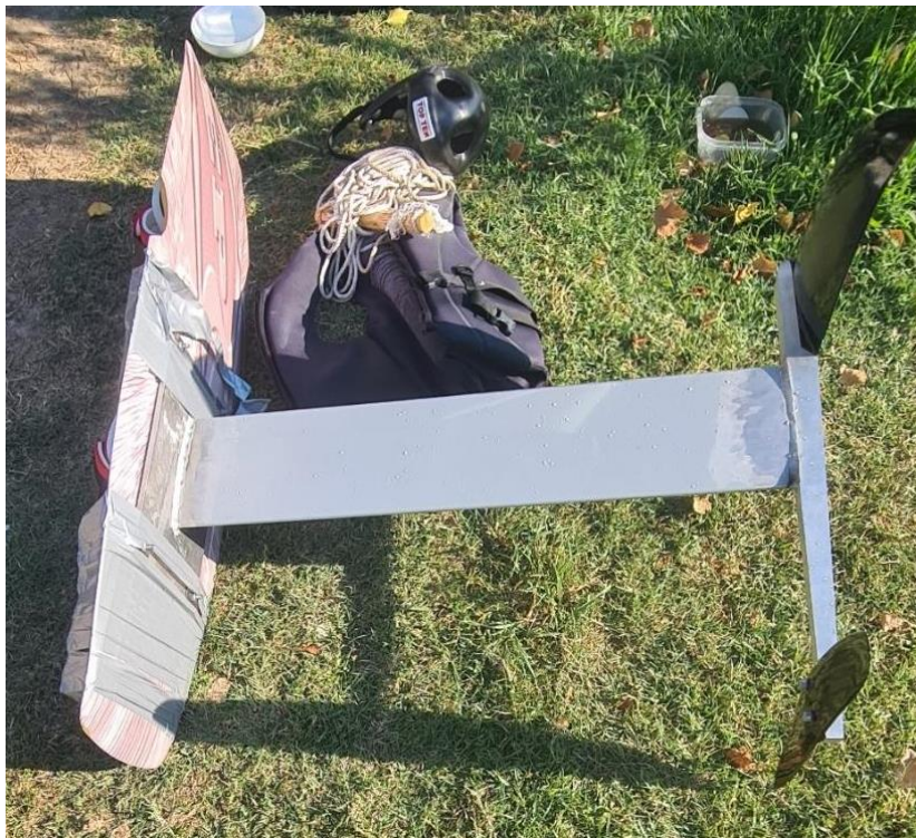
Slika 57-Složen i montiran hydrofoil na wakeboard
