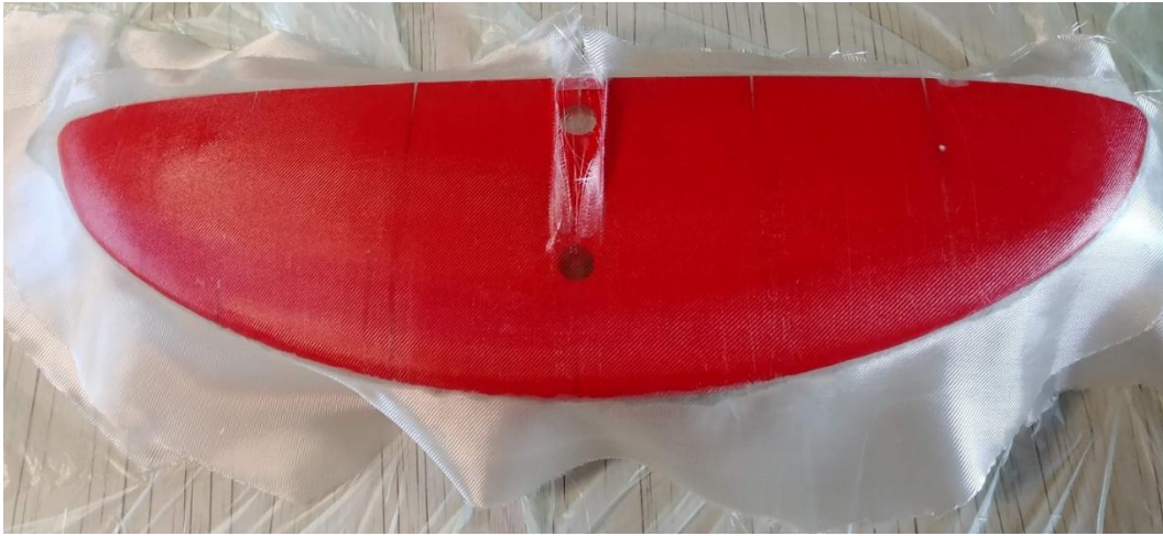
Slika 51-Slojevito pojačanje prednjeg krila
