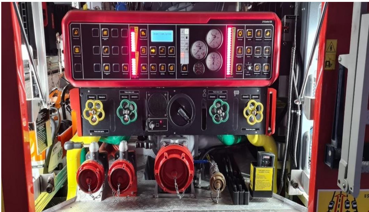
Slika 13. Centrifugalna pumpa NVT G-110.[7]
