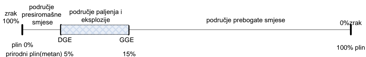
Slika 5. Prikaz granice paljenja ili eksplozivnosti
