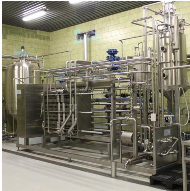
*Slika 5. Protočni pasterizator [12]*
