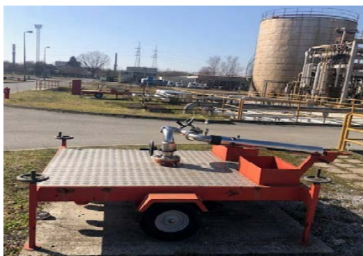
Slika 17. Mobilni bacač voda/pjena tipa "Juring" na KP-6 [5]
