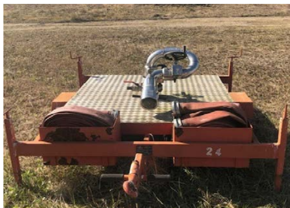
Slika 18. Mobilni bacač voda/pjena na KP-7.[5]
