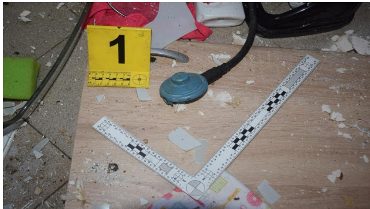
Slika 40. Regulator spojen na gumeno crijevo [18]
