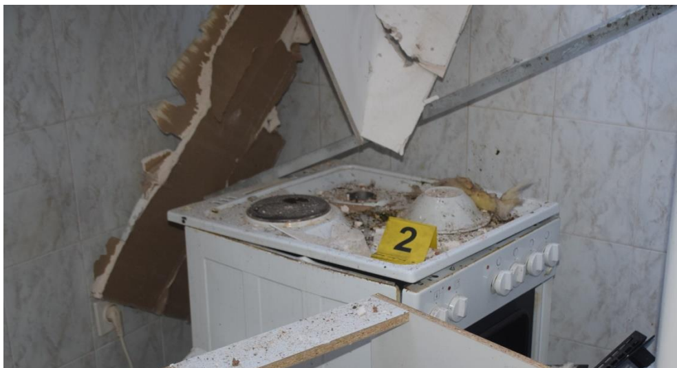
Slika 41. Prikaz regulatora u zatvorenom položaju [18]
