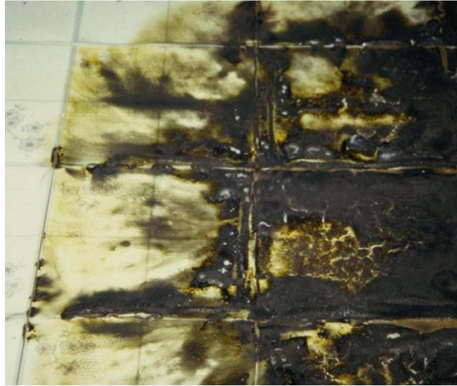
Slika 20. Znakoviti trag izgaranja lokve gorive kapljevine [12]
