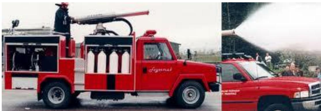
Slika 2. Visokotlačni monitor montiran na vozilo.[5]
