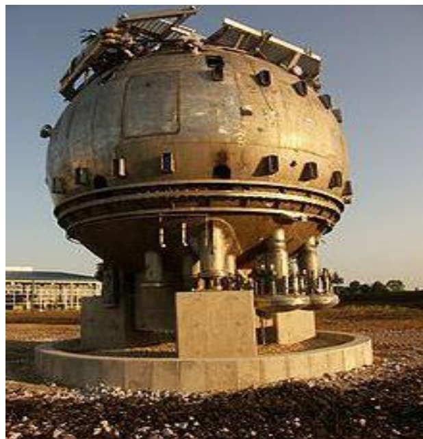
Slika 15. Komora na mjehuriće
