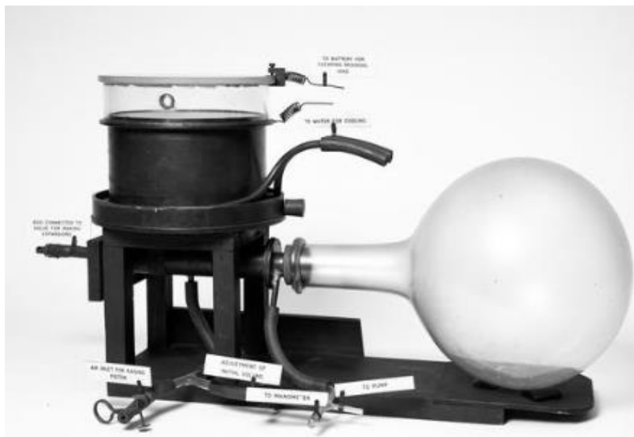
Slika 13. Originalna maglena komora napravljena u Cavendishev laboratoriju
