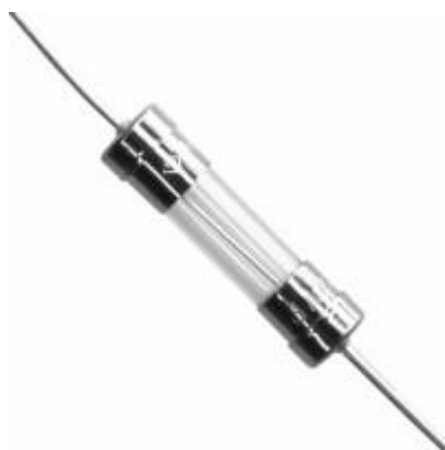
Slika 27. Predodžba osigurača - spori ZKTM 2.5A 250V ( 5x15mm ) [15]
