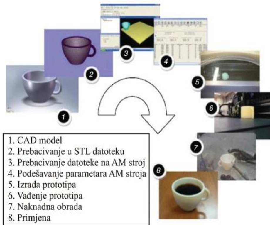
Slika 7. Koraci izrade prototipa aditivnim postupkom [1]
