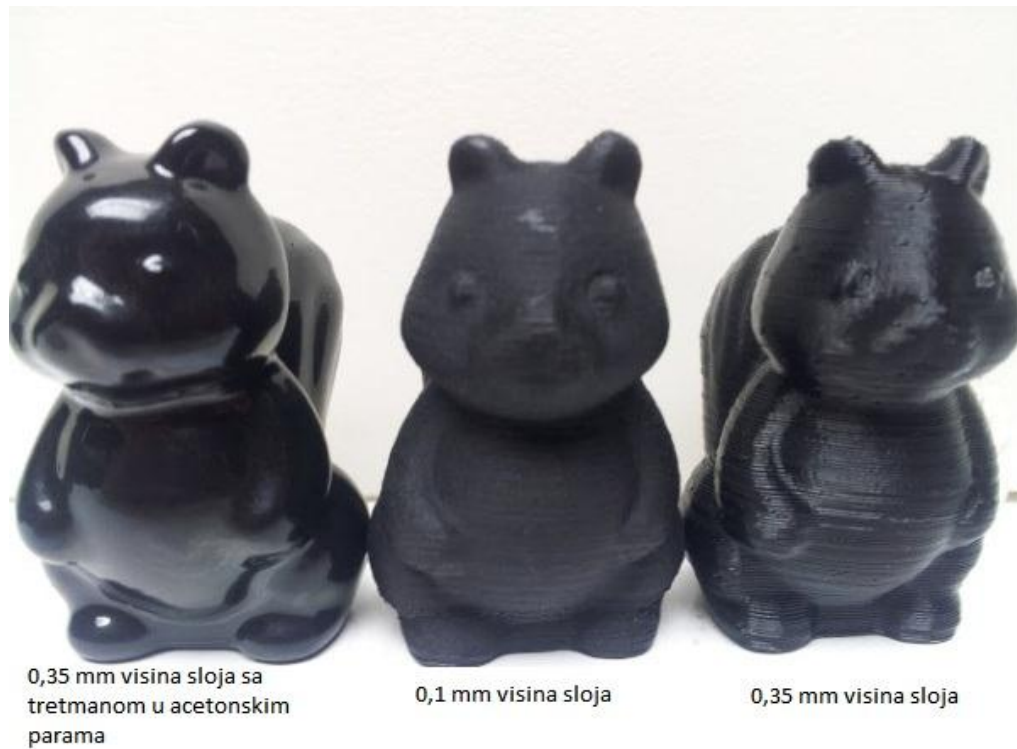
Slika 11. Obradak podvrgnut obradi u acetonskim parama [17]
