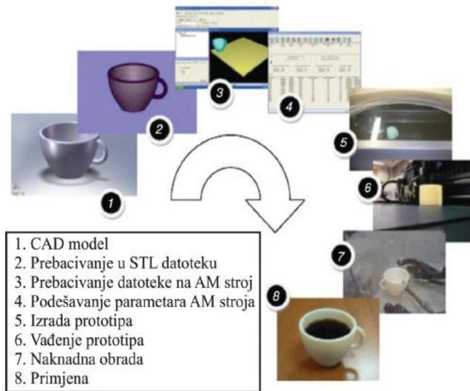
Slika 7. Koraci izrade prototipa aditivnim postupkom [1]
