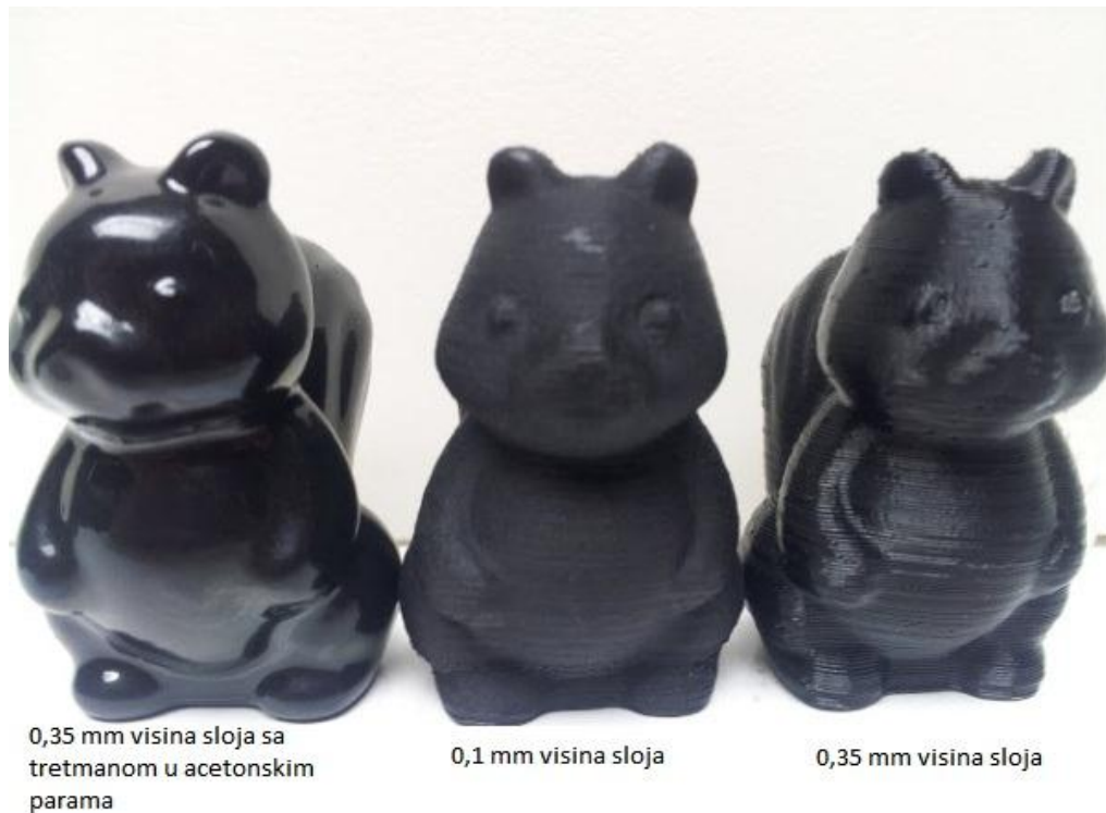
Slika 11. Obradak podvrgnut obradi u acetonskim parama [17]
