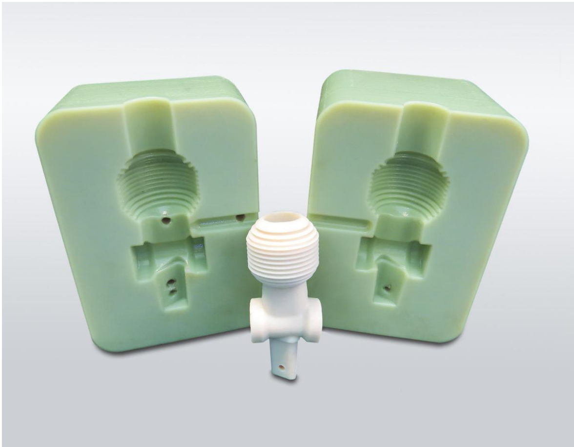
Slika 6. Primjer RT (Rapid Tooling) korištenja AM tehnologije
