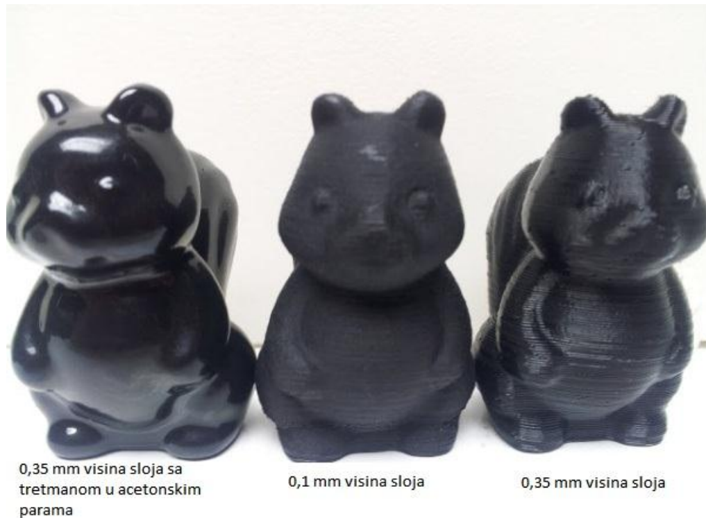
Slika 11. Obradak podvrgnut obradi u acetonskim parama [17]
