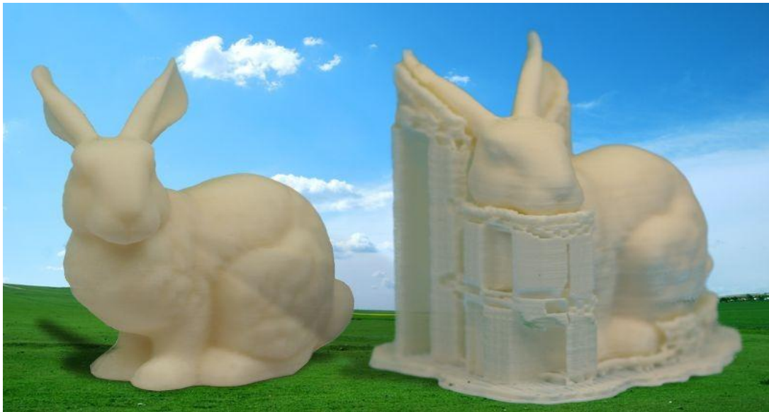
Slika 10. Primjer izratka nakon i prije uklanjanja potporne strukture [16]
