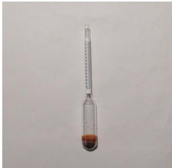
**Slika 4:** Moštomjer (areometar) (vlastiti izvor)
