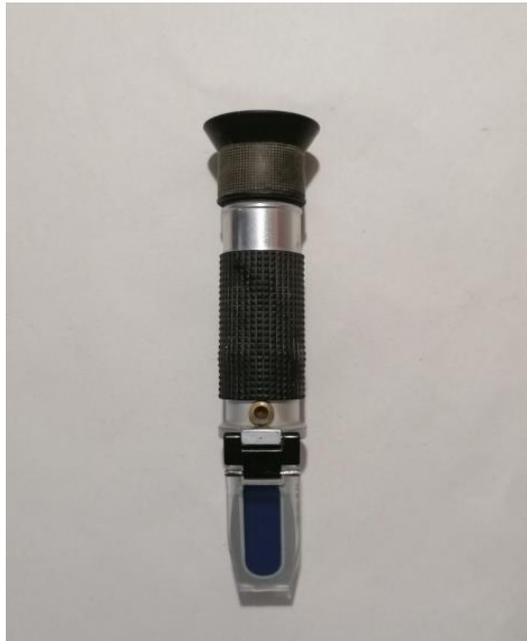
**Slika 5:** Refraktometar (vlastiti izvor)
