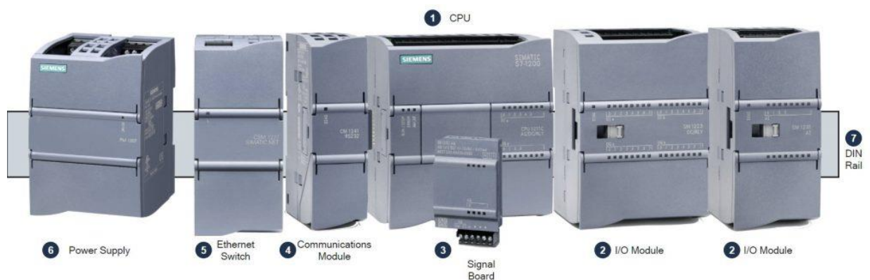
Slika 2. Predodžba PLC-a S7-1200 sa raznim modulima [4]
