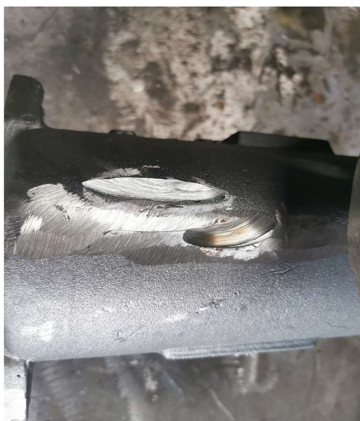
Slika 28. Priprema odljevka sa greškom za zagrijavanje u peći: a) brušenje pukotine na odljevku, b) odljevak spreman za zagrijavanje
