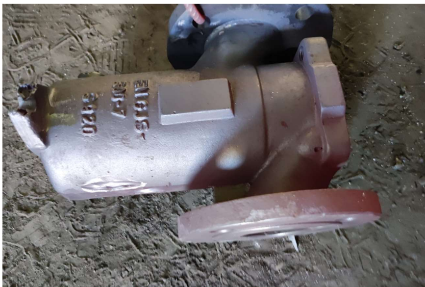
Slika 29. Odljevak zagrijan u peći
