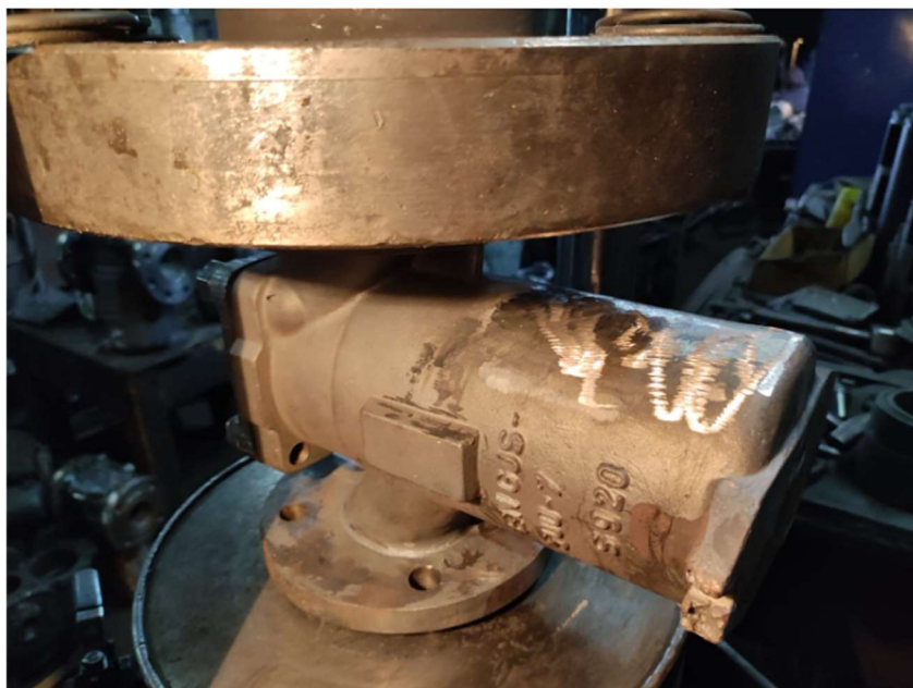
Slika 33. Ispitivanje odljevka na tlačnoj probi
