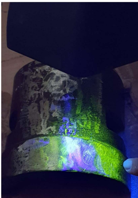
Slika 17 Ispitivanje ležaja magnetskom metodom
