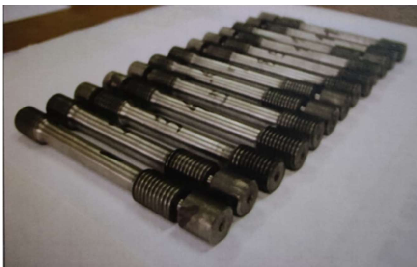
Slika 26. Ispitni uzorci za ispitivanje vlačnih svojstava nodularnog lieva
