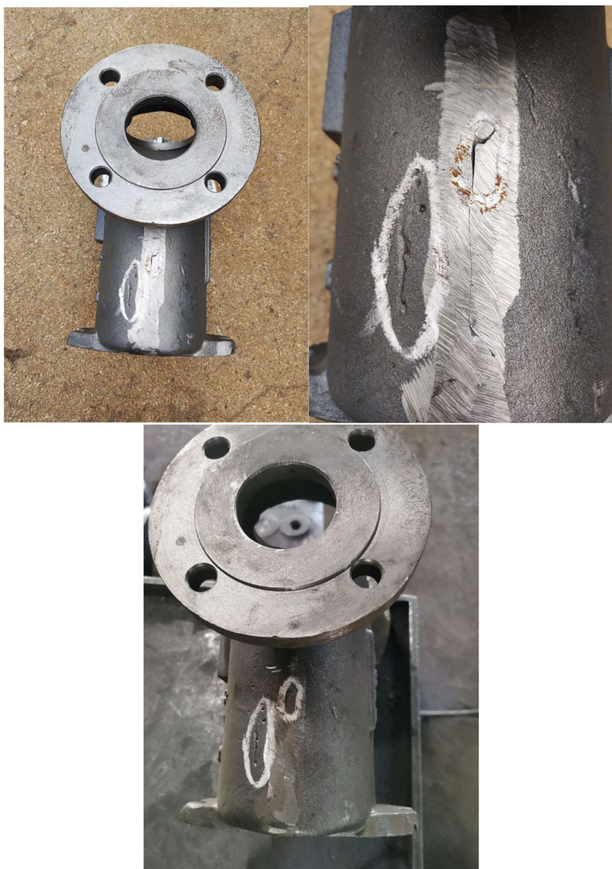
Slika 27. Indicirana greška na kućištu filtra KSF DN65
