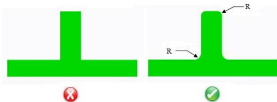
Slika 4. Primjer modeliranja polumjera [5]
