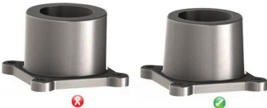
Slika 9. Pravilno konstruiranje modela [5]
