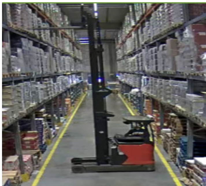
Slika 21. Regalni viličar Linde R20 u radu
