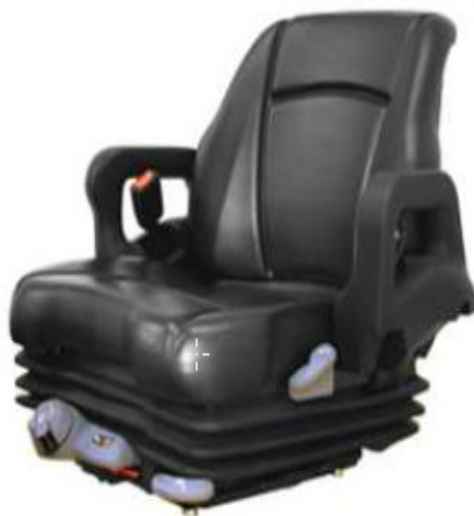
Slika 23. Model automatski podesivog sjedala viličara [18]
