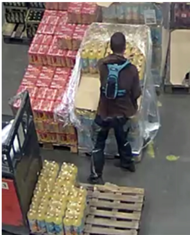
Slika 15. Pickbyvoice vesta – oprema za držanje prijenosnog prijemnika sustava pickbyvoice u promatranom LDC
