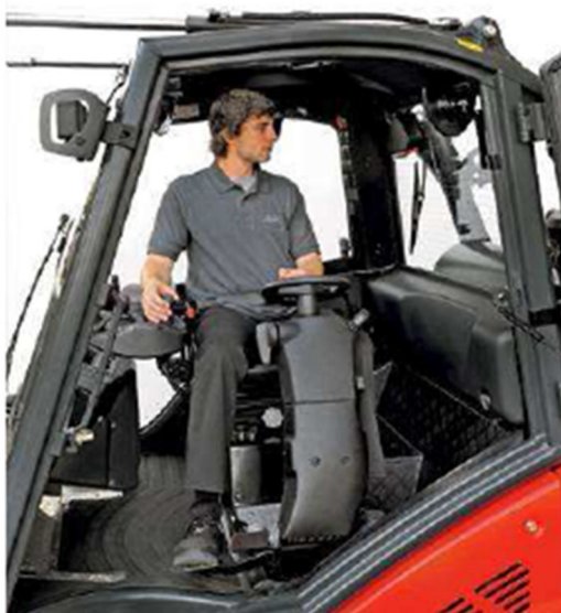
Slika 24. Model Linde viličara sa zaokretnom konzolom sjedišta
