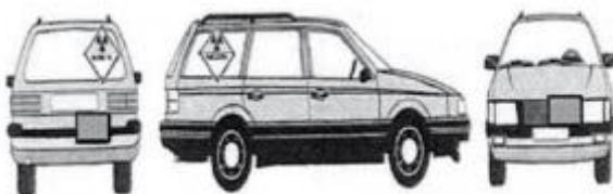
Slika 5. Označeno vozilo za prijevoz radioaktivnih tvari
