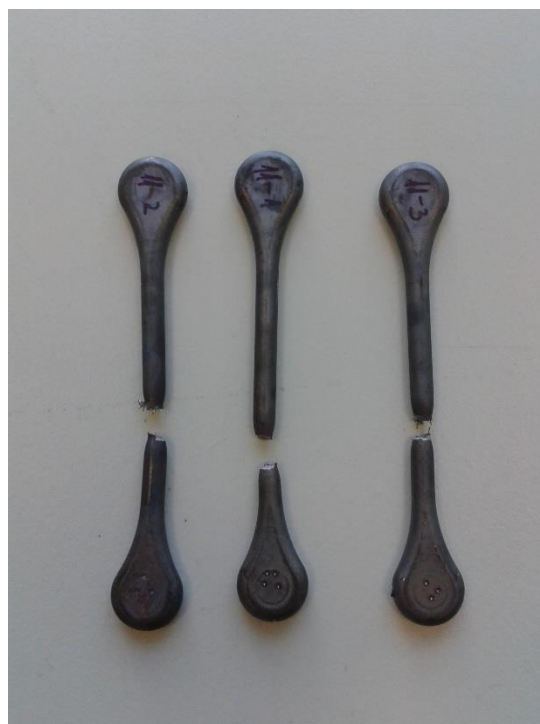
Slika 33.: MIM i HIP epruvete nakon ispitivanja
