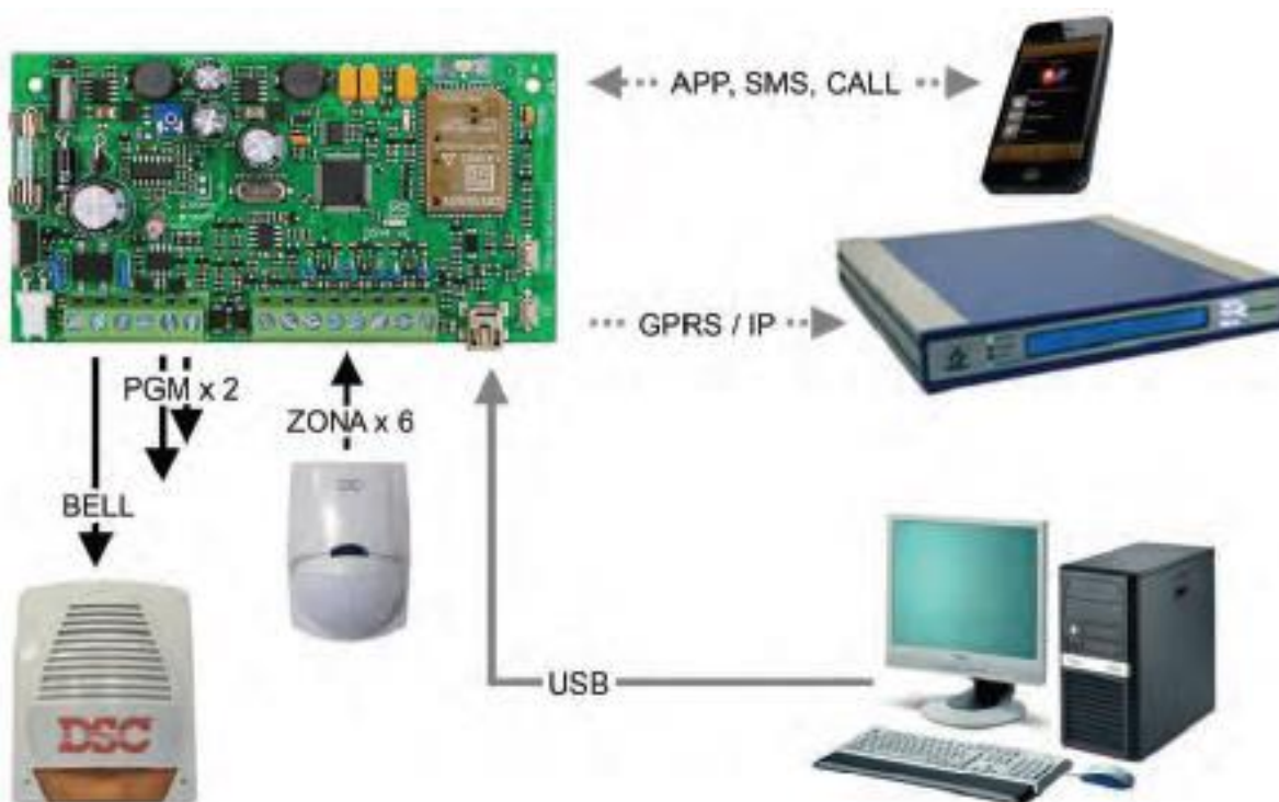
Slika 11. Kompaktna alarmna centrala s integriranim GSM/GPRS dojavnikom SL-GSV4 [2]
