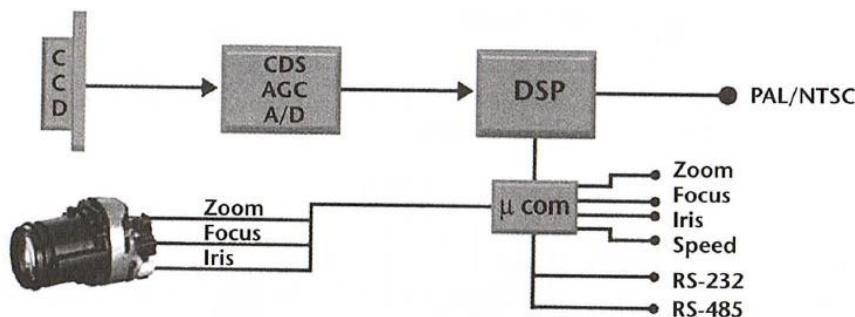
Slika 13. Prikaz funkcioniranja kamere s motor zoom objektivom [9]
