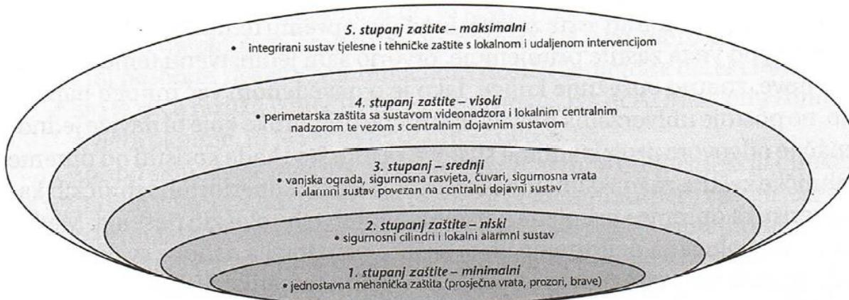
Slika 1. Stupnjevi tehničke zaštite [9]
