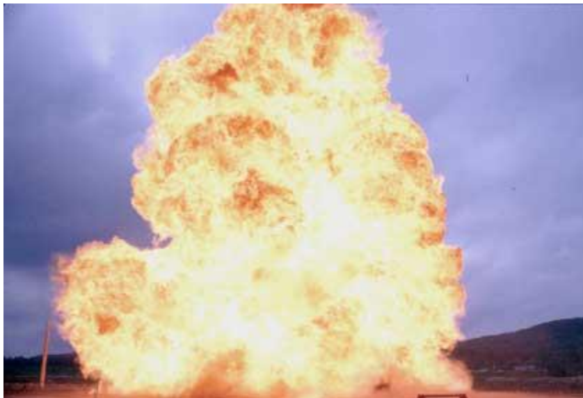
Slika 4. Vatrene kugla uzrokovana eksplozijom propana (BLEVE) [17]
