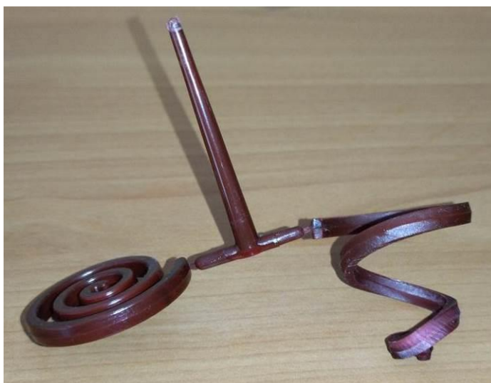
Slika 55. Primjer izvinutog otpreska iz polimernog kalupa
