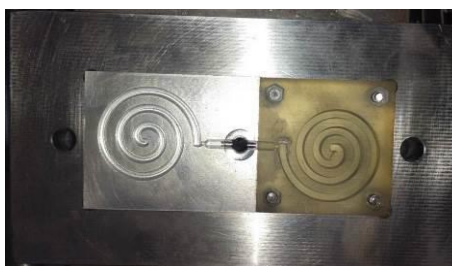
Slika 8. Nepomični alat sa polimernim kalupom za drugi i treći postupak injekcijskog prešanja
