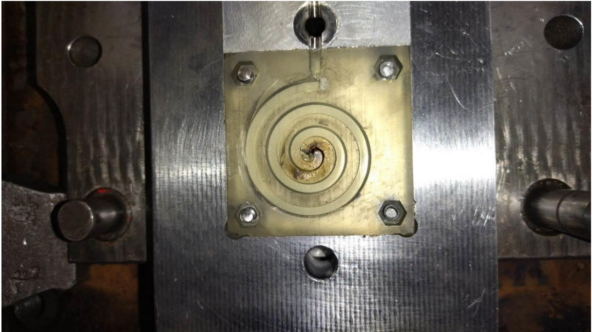
Slika 63. Izgled polimernog kalupa nakon četrdesetog otpreska (nepomični alat)
