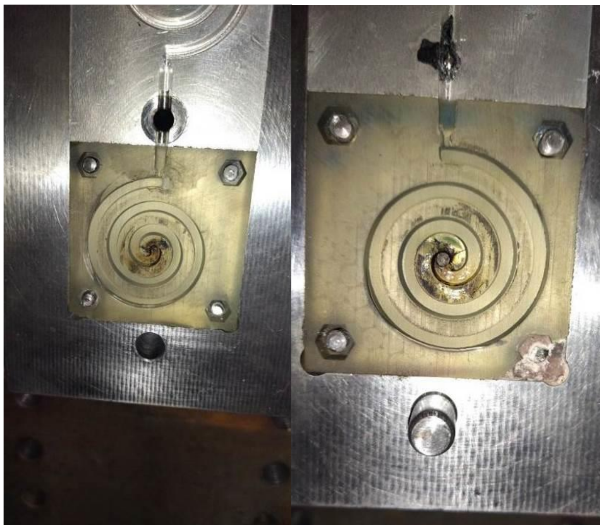
Slika 61. Izgled kalupa nakon trideset otpresaka
