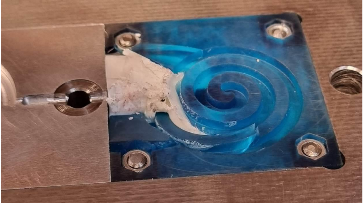
Slika 49. Oštećeni polimerni kalup prvog eksperimenta injekcijskog prešanja (1)
