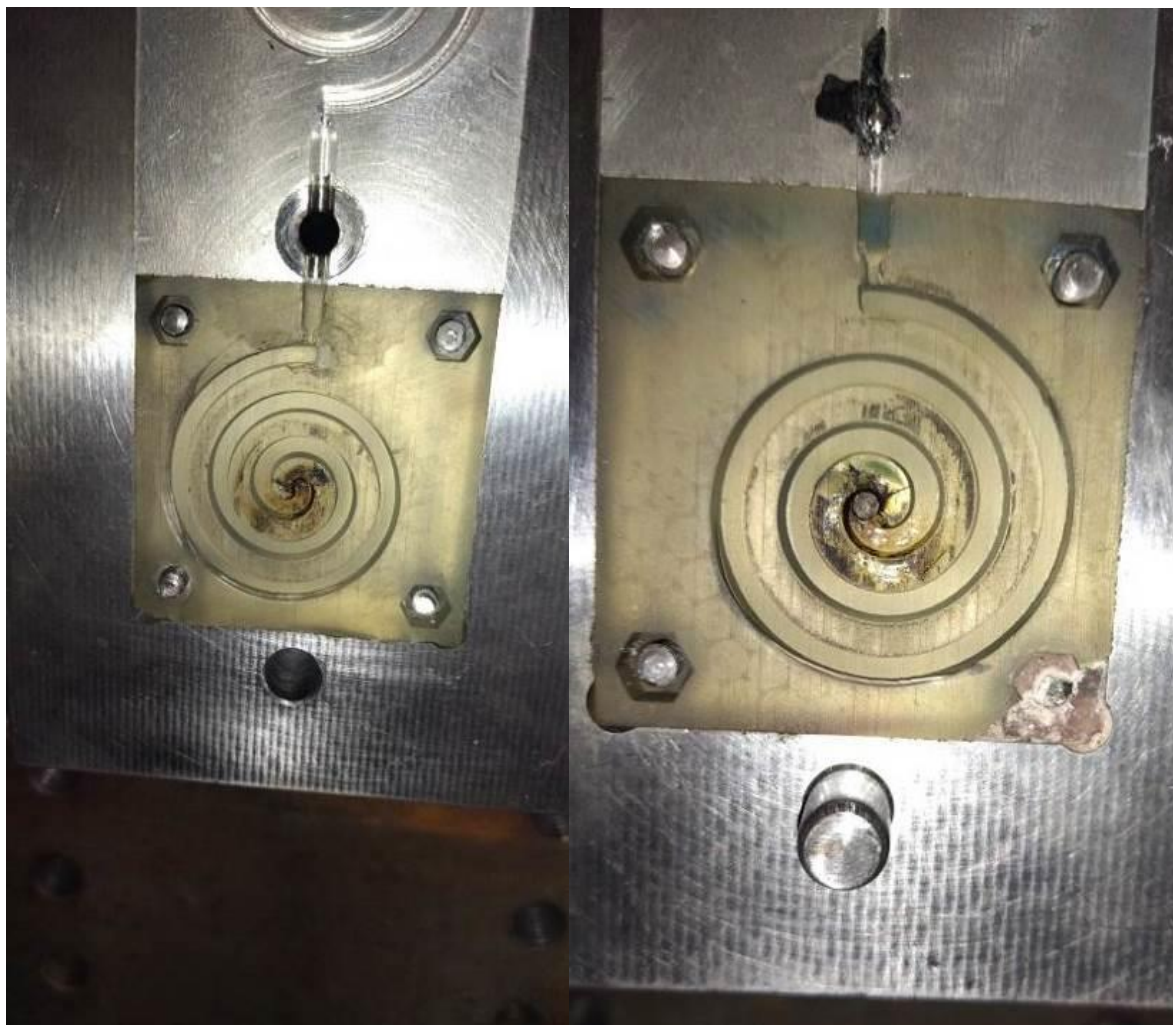
Slika 61. Izgled kalupa nakon trideset otpresaka
