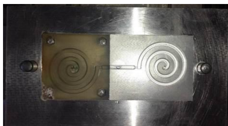
Slika 8. Nepomični alat sa polimernim kalupom za drugi i treći postupak injekcijskog prešanja
