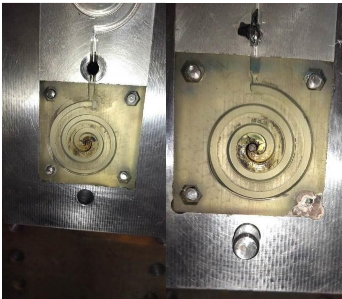
Slika 61. Izgled kalupa nakon trideset otpresaka
