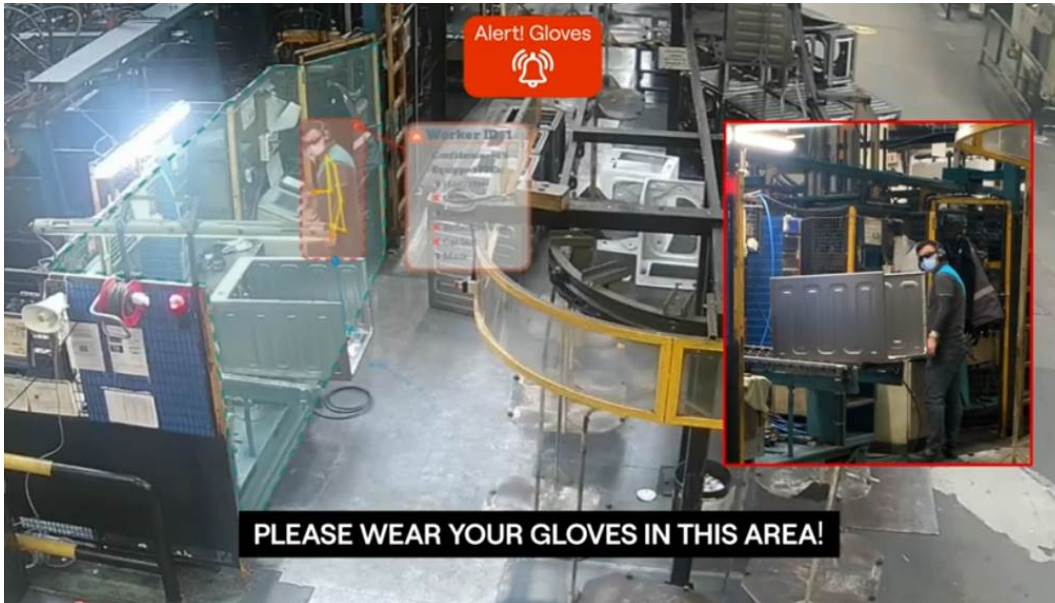
Slika 63: Zvučno upozorenje za nenošenje zaštitnih rukavica [83]
