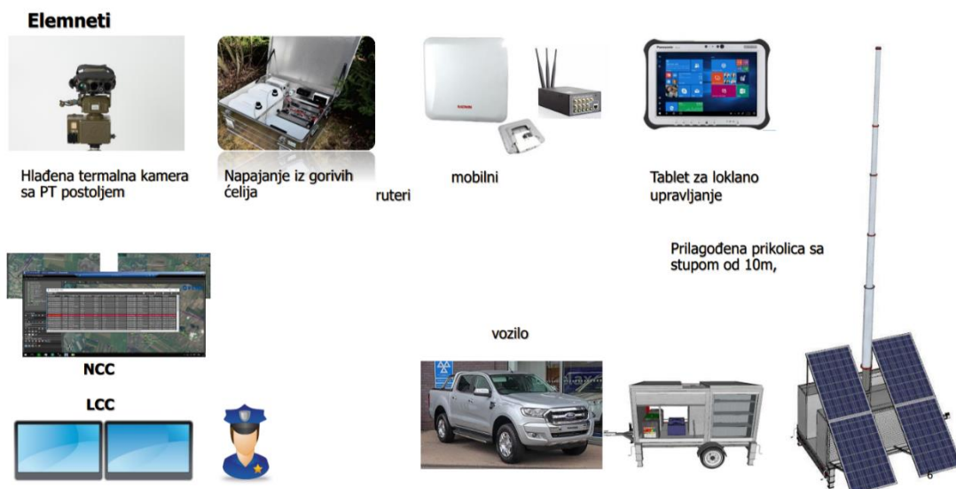
Slika 9. Predodžba elemenata mobilnih uređaja na prikolici
