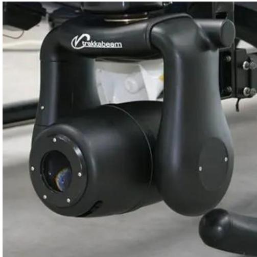
Slika 15. Predodžba Trakka a800 reflektora. Izvor [8]
