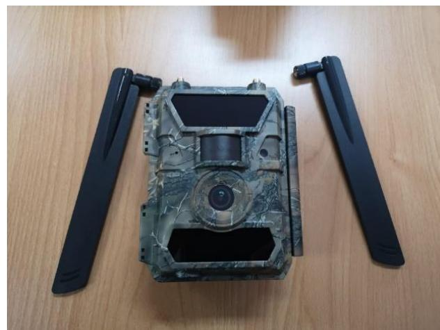
Slika 2. Predodžba dnevno-noćne kamere, s antenama za GPRS i GPS signal
