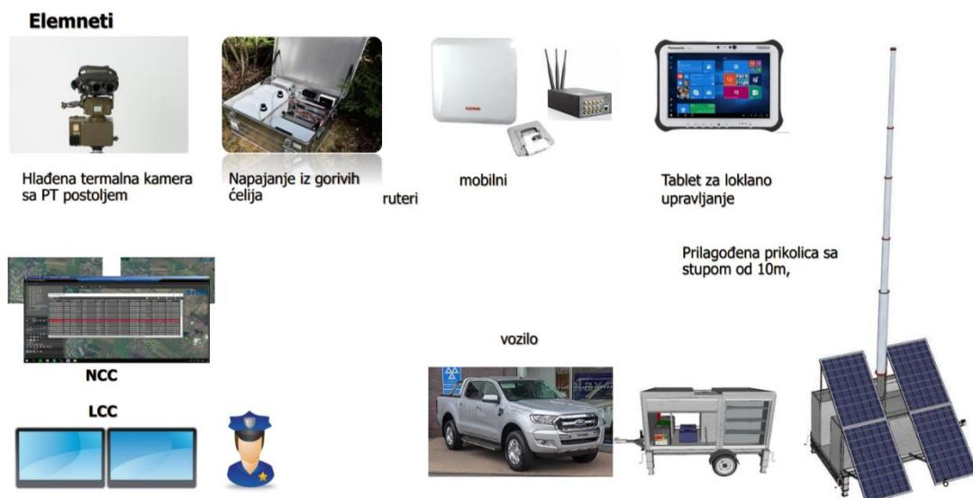
Slika 9. Predodžba elemenata mobilnih uređaja na prikolici
