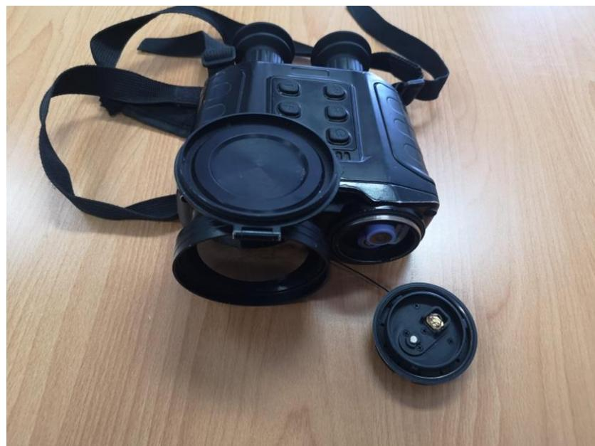
Slika 8. Predodžba ručne termovizijske kamere „Guide IR“
