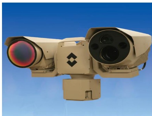
Slika 10. Predodžba sustava dnevno/noćne kamere i termovizijske kamere sa zajedničkim pan tilt mehanizmom
