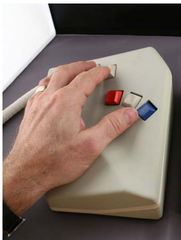
Slika 27 Računalna periferija - bat tipkovnica
