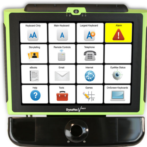
Slika 15 Uređaj za komunikaciju očima [17]
