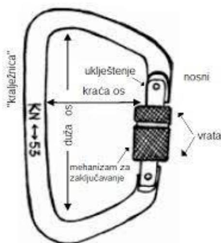
Slika 24: Spojni element [14]
