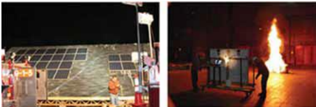
Slika 16. Osvjetljenje fotonaponskog panela reflektorima i plamenom [9]
