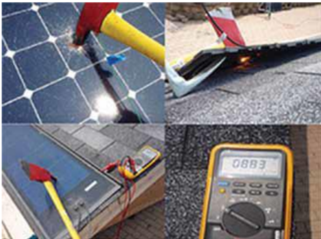
Slika 17. Inducirani opasni napon nakon oštećivanja solarnog modula [9]
