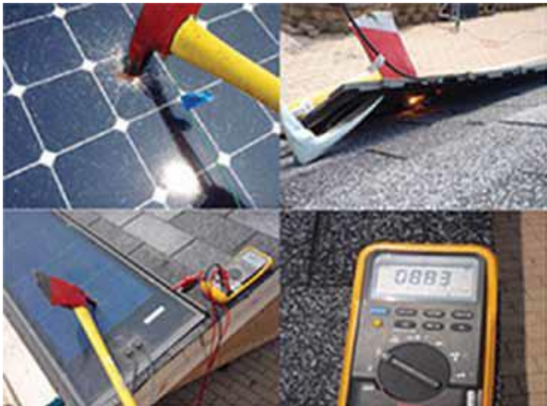
Slika 17. Inducirani opasni napon nakon oštećivanja solarnog modula [9]
