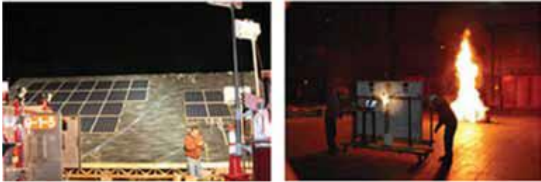
Slika 16. Osvjetljenje fotonaponskog panela reflektorima i plamenom [9]
