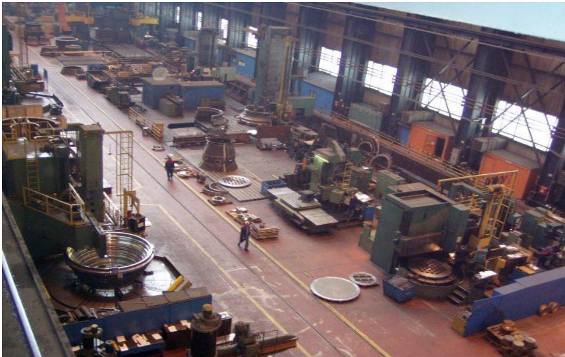
Slika 4: Hala 1 dimenzija 32×165 m, ukupno 9 dizalica, max. nosivost najveće dizalice 2500 kN
