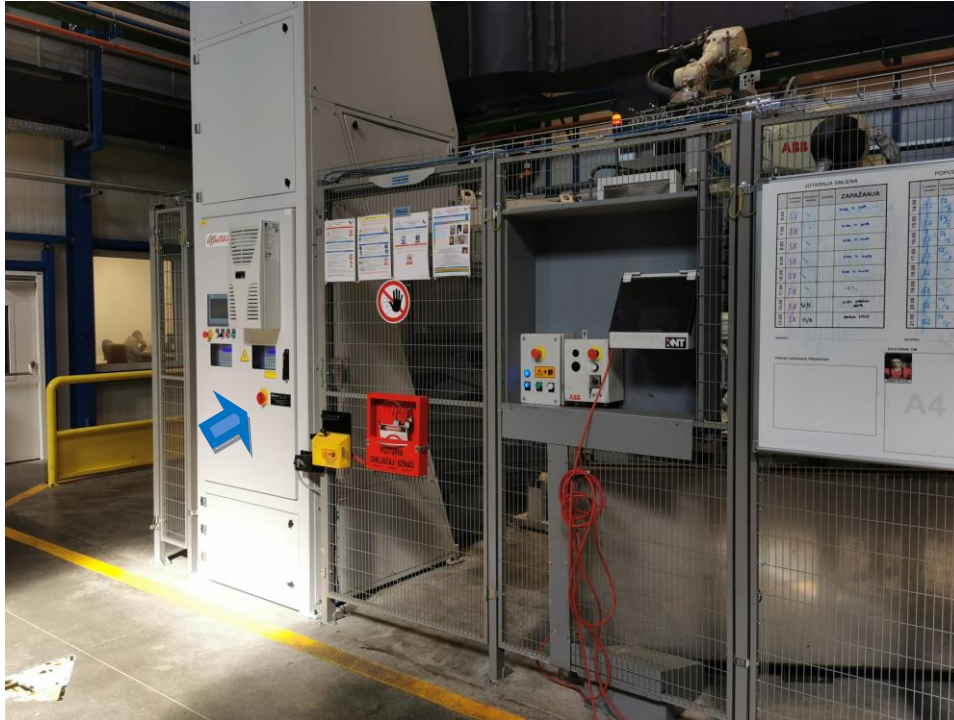
Slika 3: Sklopka za zaustavljanje u slučaju nužde
