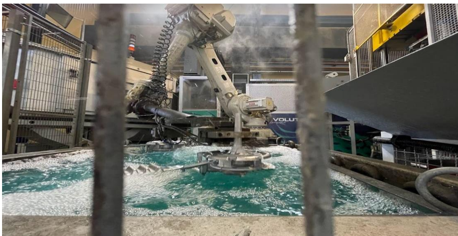
Slika 1: Prikaz hlađenja odlijevka
