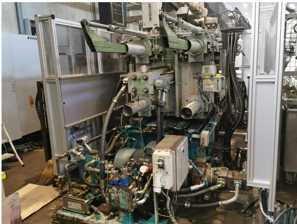
Slika 8: Pogonski sklop stroja za tlačni ljev
