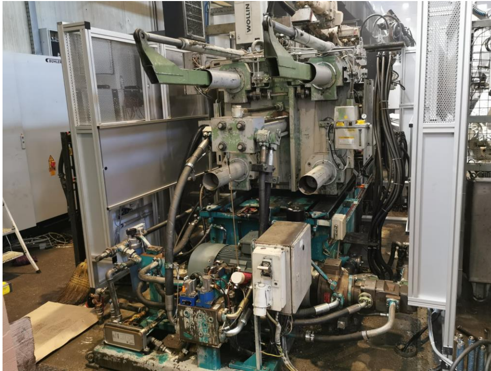
Slika 8: Pogonski sklop stroja za tlačni ljev
