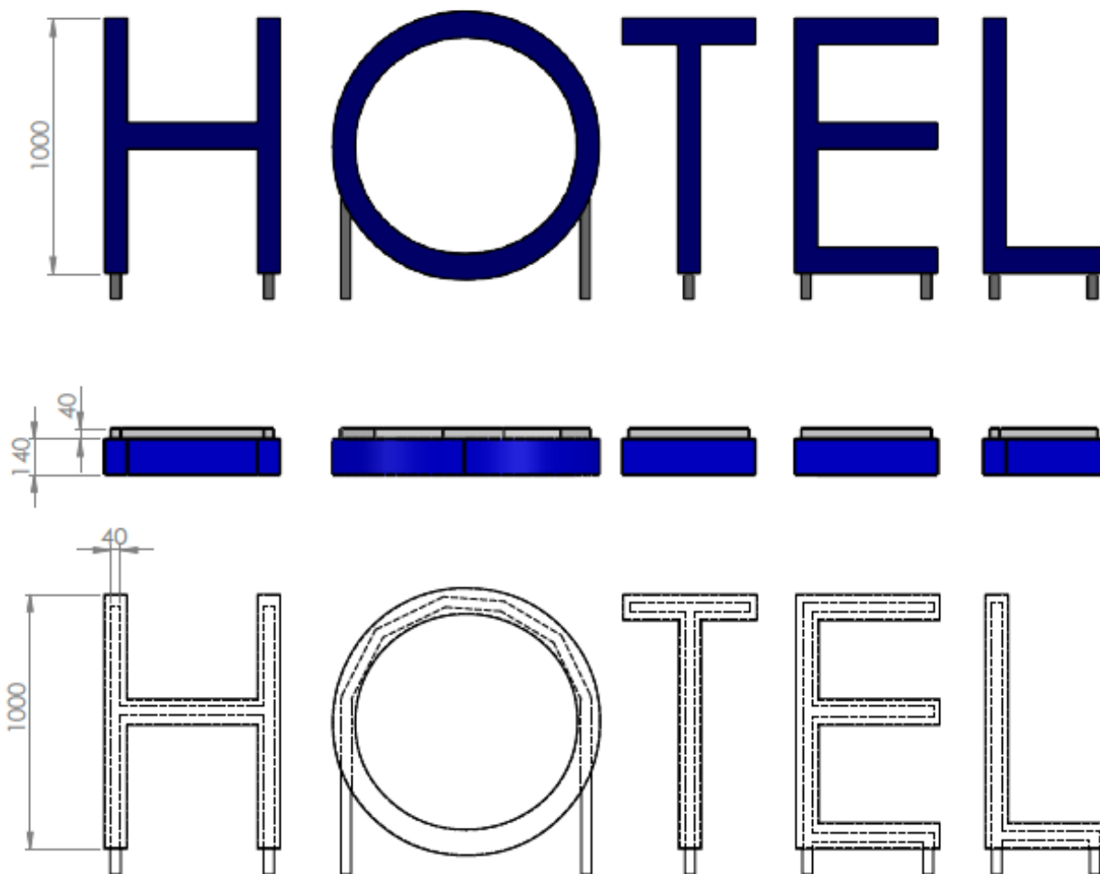
Slika 14. Primjer podkonstrukcije za samostojeća 3D slova
