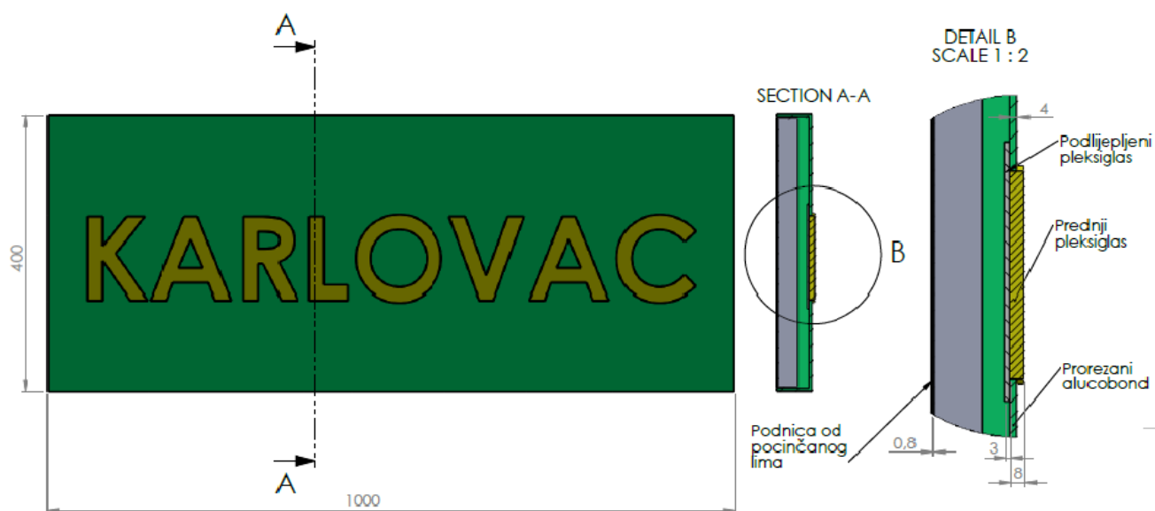
Slika 25. Prikaz dijelova svjetleće kutije
