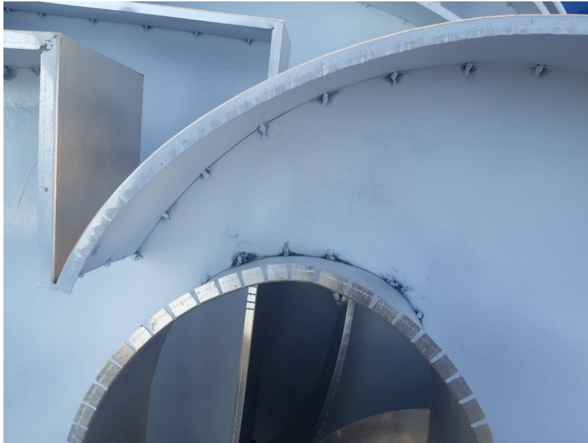
Slika 6. Prikaz savijanja bočne strane 3D slova
