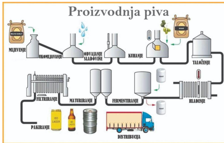
Slika 1. Grafički prikaz toka proizvodnje piva
