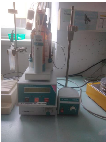
Slika 9. TITRINO 702SM, uređaj za određivanje pH vrijednosti
