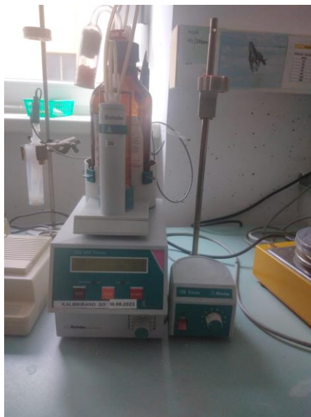
Slika 9. TITRINO 702SM, uređaj za određivanje pH vrijednosti
