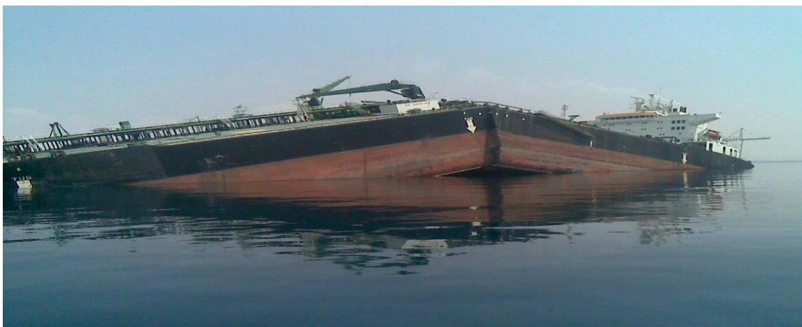
Slika 5. Puknuće broda zbog nepravilne izmjene balasta
