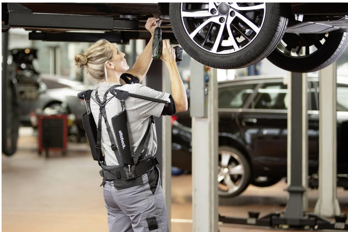
Slika 20. Primjer egzoskeleta u industriji [28]
