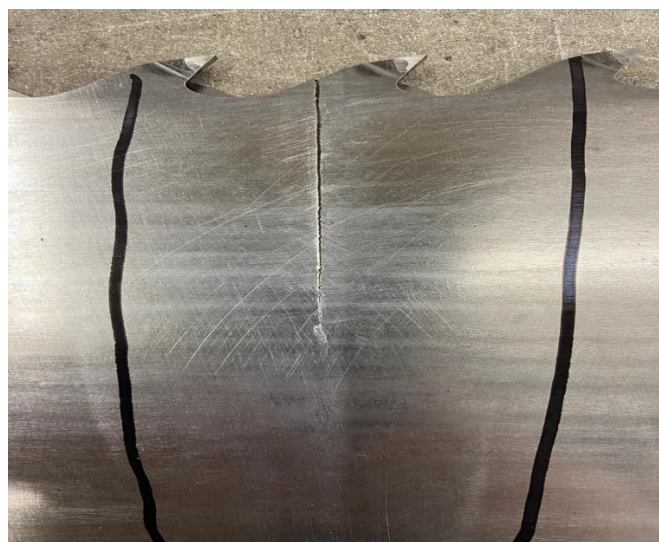
Slika 17. Pila spremna za predgrijavanje [8]
