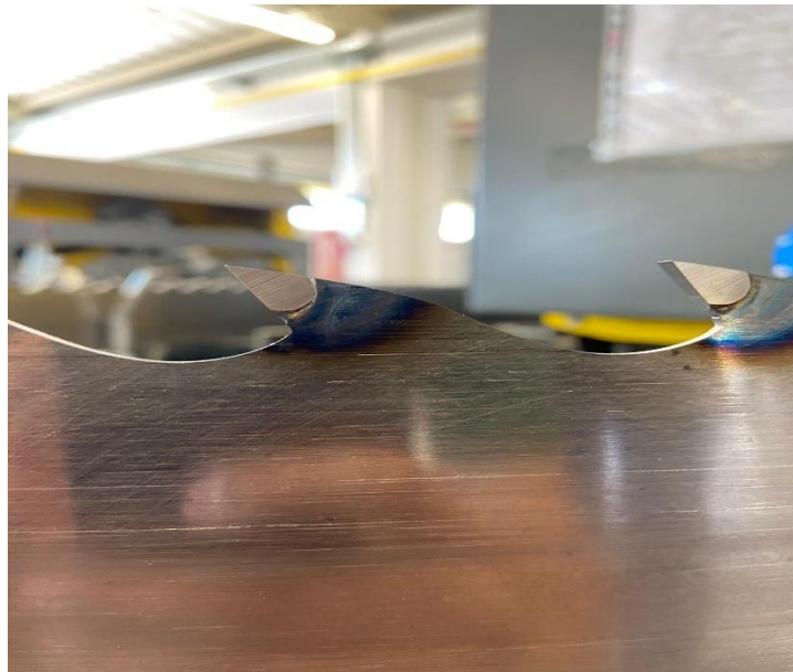
Slika 12. Zub s vrhom od stelita [8]
