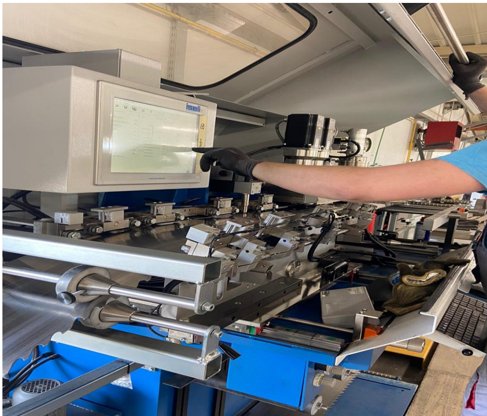
Slika 8. Automatski stroj za napinjanje [8]
