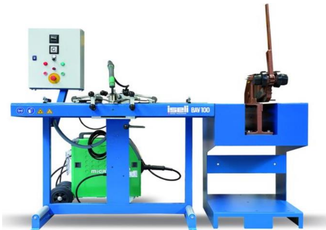
Slika 5. Stol za rezanje i varenje tračnih pila [10]
