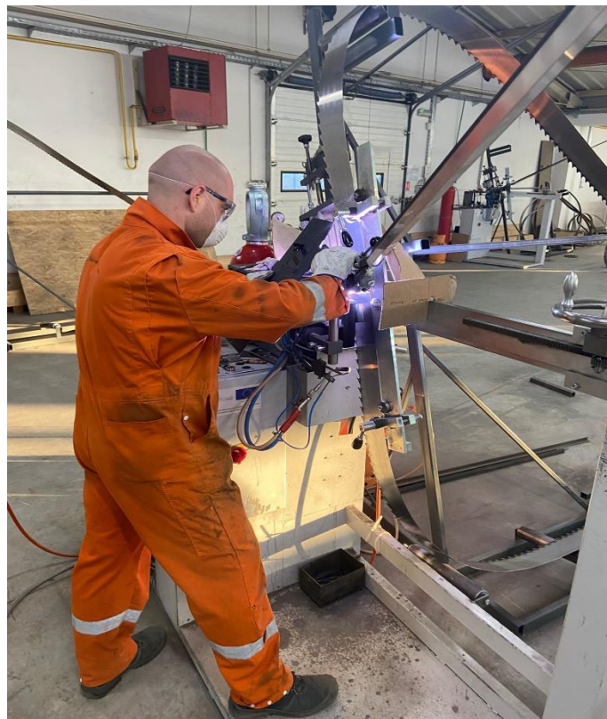
Slika 14. Radnik na stroju za stelitiranje [8]
