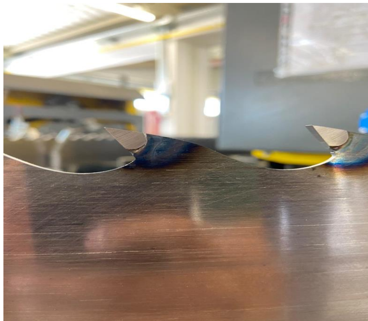
Slika 21. Pravilno izbrušena pila [8]
