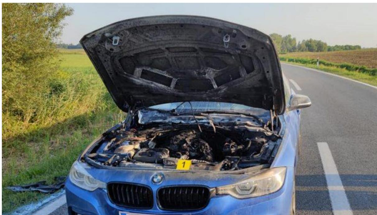
Slika 12. Požar nastao kvarom na elektroinstalacijama vozila [22]
