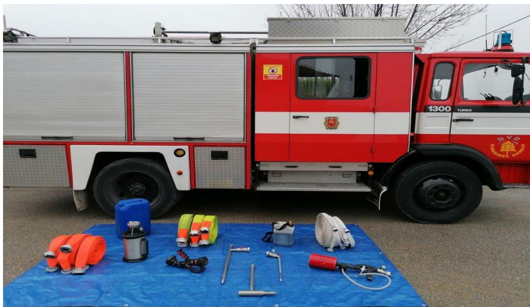
Slika 7. Vatrogasno vozilo za gašenje požara motornih vozila [14]
