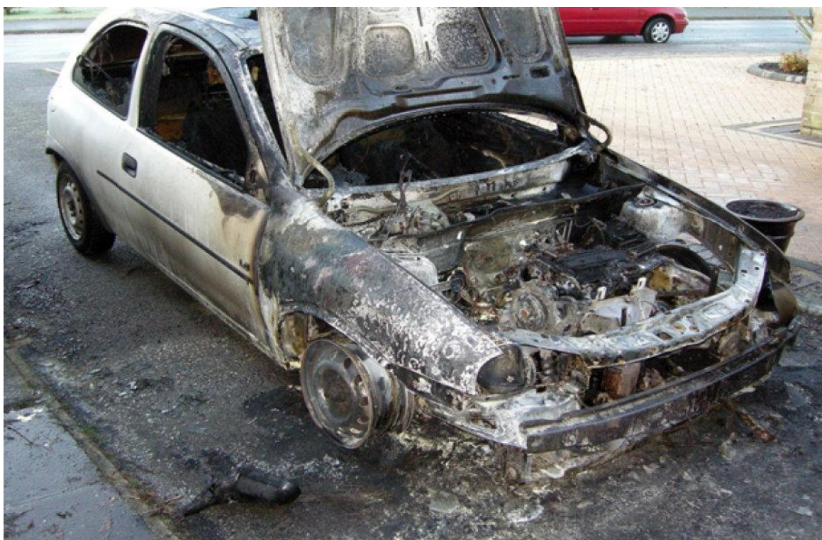
Slika 10. Požar u motornom prostoru vozila izazvan curenjem zapaljive tekućine
