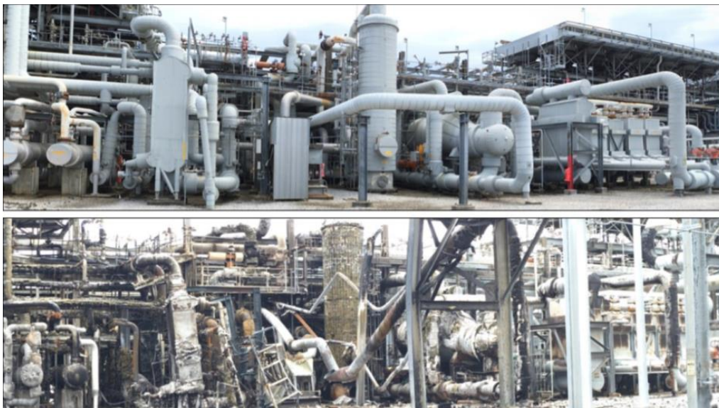
Slika 2. Usporedba požarom stradale kompozicije (dolje) i identične požarom netaknute kompozicije (gore) za preradu sirovog plina [9]
