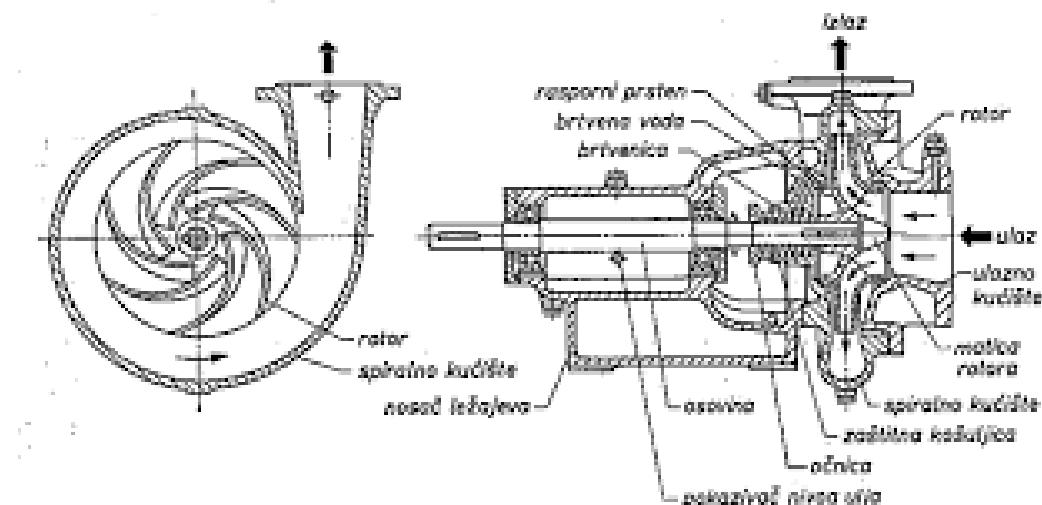
Slika 1. Osnovni dijelovi centrifugalne pumpe (Izvor:<https://core.ac.uk/>) [10]
