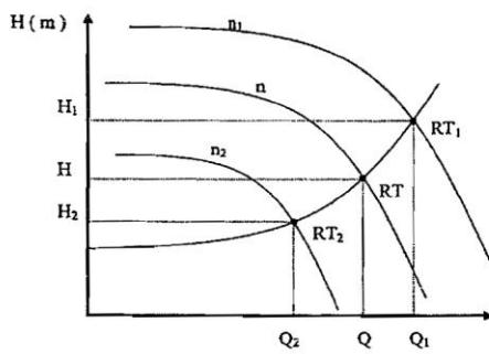
RT – radna točka ( $Q$  i  $H$ ) pri broju okretaja rotora pumpe ( $n$ )
