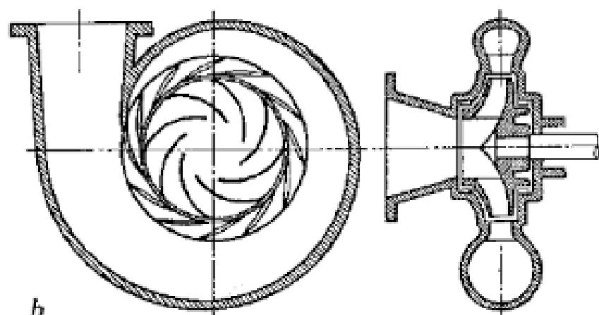
Slika 3. Difuzorsko kućište centrifugalne pumpe (Izvor: <https://core.ac.uk/>) [12]
