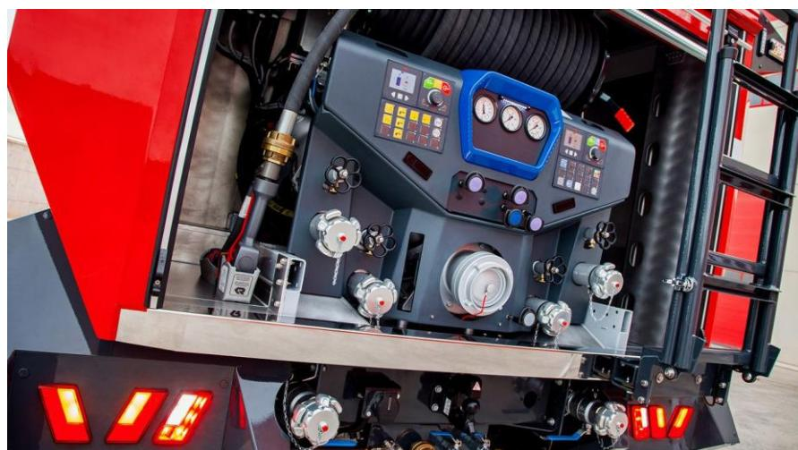
Slika 10. Pumpa ugrađena u vatrogasno vozilo (Izvor:
