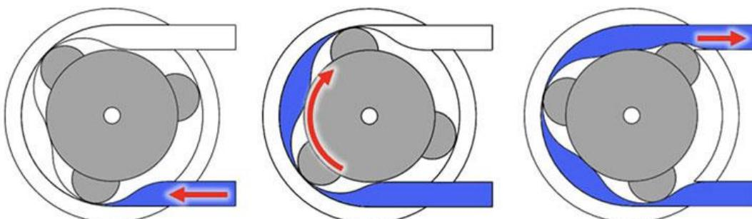
Slika 21. Princip rada pumpe za pretakanje opasnih tvari (Izvor:
