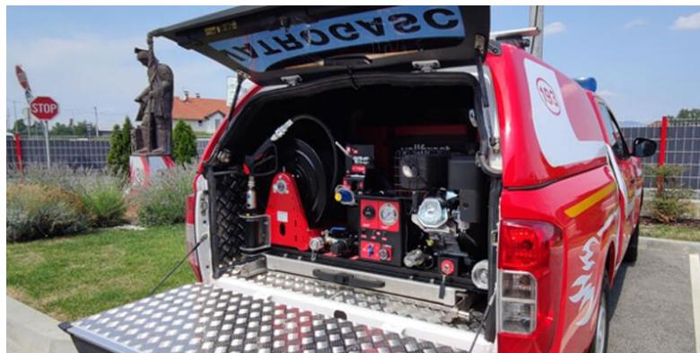
Slika 17. Visokotlačni modul ugrađen u vozilo (Izvor: <https://vatropromet.hr/>)
